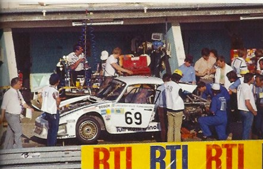
Motorschaden bei den 24 Stunden von Le Mans 1981. Die Mechaniker von Jan Lundgårdh bauen in den Boxen den Motor vom Typ 935/02 aus.
